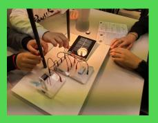
**FASE 1:** Collegamento del pannello alla ruota/elica/led
