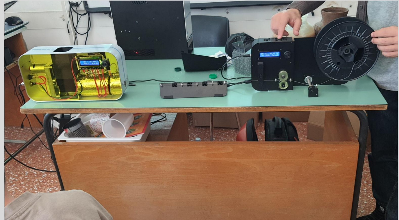
Dispositivi per la produzione del filamento «BUNDLE FELFIL EVO & SPOOLER»
